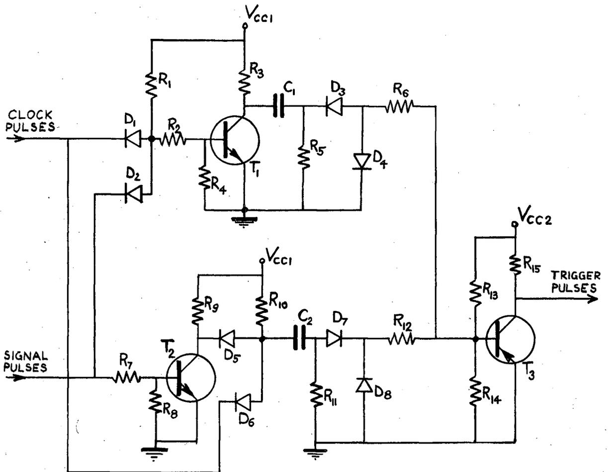
Fig. 12. Trigger Circuit
