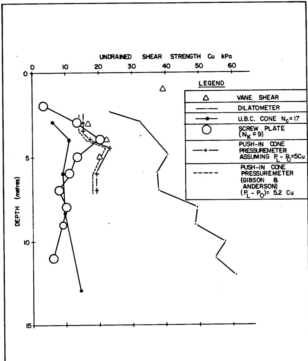
FIGURE 4.23 - COMPARISON OF UNDRAINED SHEAR STRENGTHS AT LANGLEY SENSITIVE CLAY SITE
