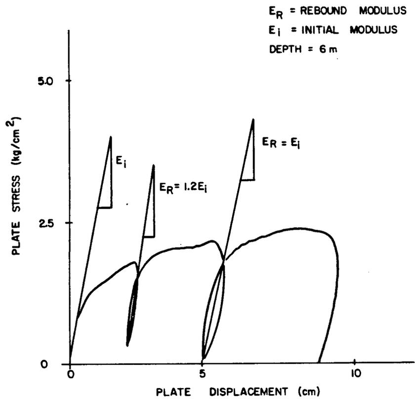
FIGURE 4-26 - LOAD TEST IN CLOVERDALE CLAY
