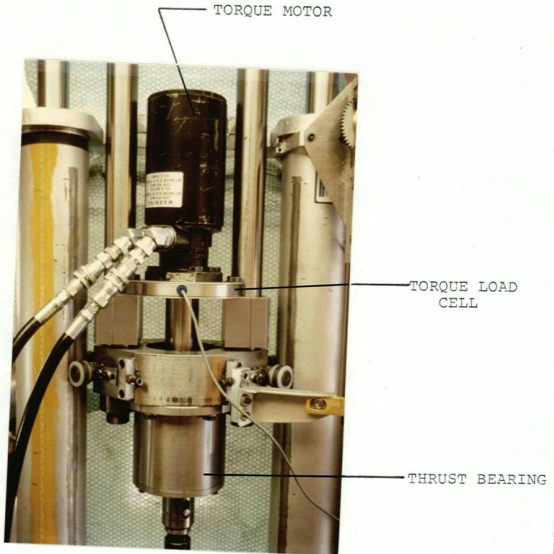
FIGURE 3.3 POSITION OF TORQUE MOTOR
