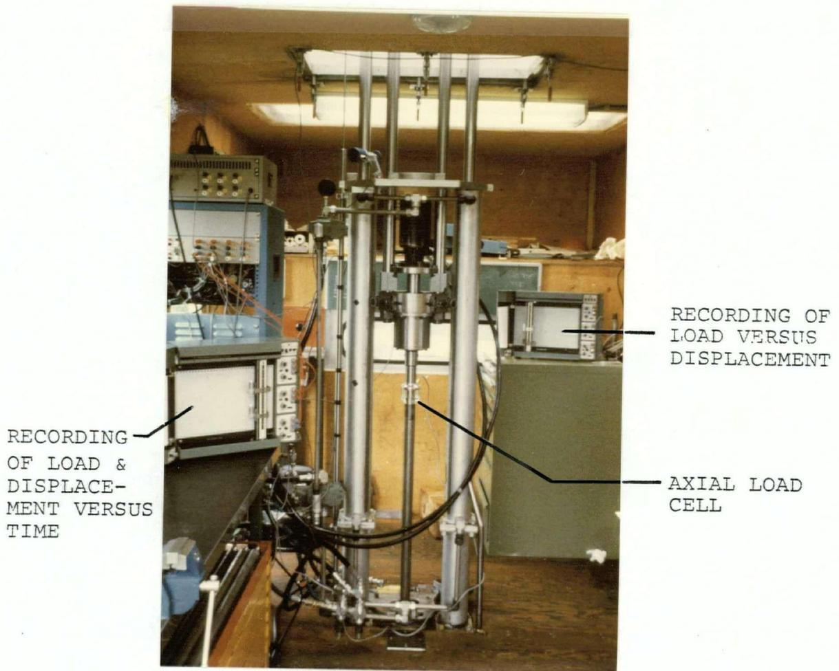
FIGURE 3.8      SCREW PLATE RECORDING SYSTEM
