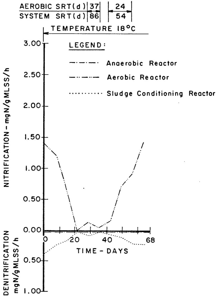
**FIG.5.3 : NITRIFICATION AND DENITRIFICATION RATES ( PHASE B ).**
